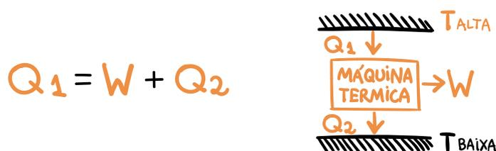
Você pode estar pensando: "se uma parte do calor foi convertida em trabalho, para onde foi o resto?". A outra parte é dissipada na fonte fria! Assim, **uma máquina térmica nunca possuirá o rendimento máximo.**
