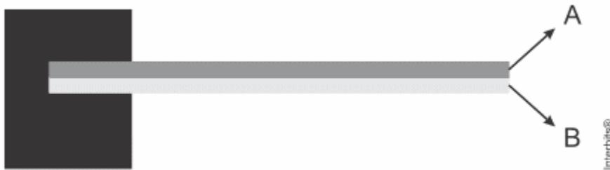
Considere que ambas as lâminas estão inicialmente sujeitas à mesma temperatura e que a relação entre os coeficientes de dilatação linear seja  $\alpha_A > \alpha_B$
